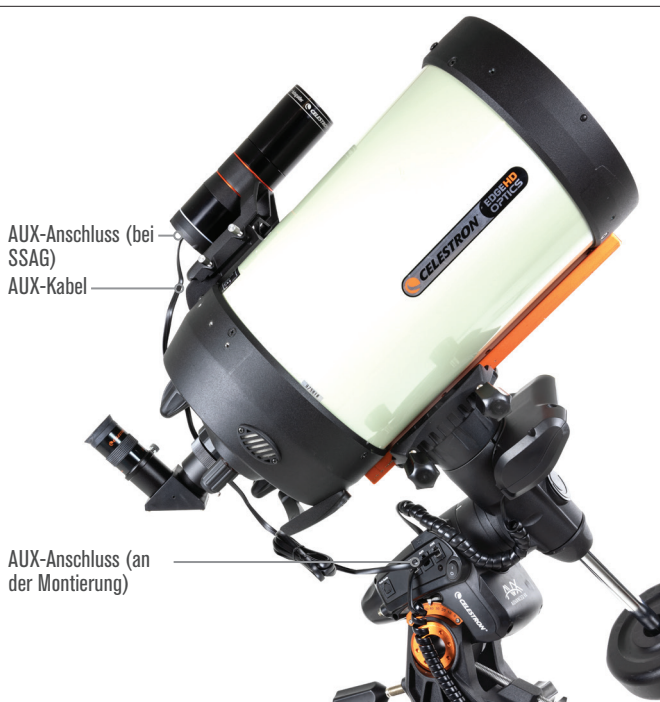
Abb. 10: Verwenden Sie das mitgelieferte AUX-Kabel, um den AUX-Anschluss von SSAG mit dem AUX-Anschluss der Montierung zu verbinden.
